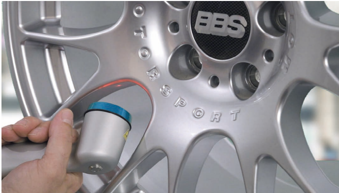
Bild 2: Das kontaktlose und zerstörungsfreie Photothermieverfahren arbeitet aus der Distanz
