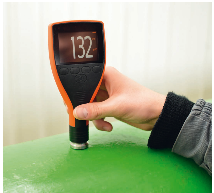
Bild 1: Berührungsbehaftete Messverfahren wie die Wirbelstromtechnik setzen direkt auf dem Werkstoff auf © shutterstock 1693123939
